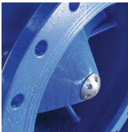
Protezione contro la corrosione per impieghi ad alta intensità con rivestimento epossidico in FBE minimo da 250 µm.
