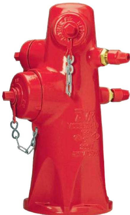
Le colonnine umide con idranti antincendio sono progettate principalmente per aree non soggette a gelo. Una colonnina umida con idrante AVK è progettata per essere facile da mantenere, consentendo ad una sola persona di eseguire operazioni di riparazione e di manutenzione di routine. L'idrante è tarato per una pressione operativa di 13,7 bar (200 PSI) e 20.6 bar (300 PSI), è omologato UL, approvato FM e soddisfa o supera i requisiti dell'AWWA C503.
