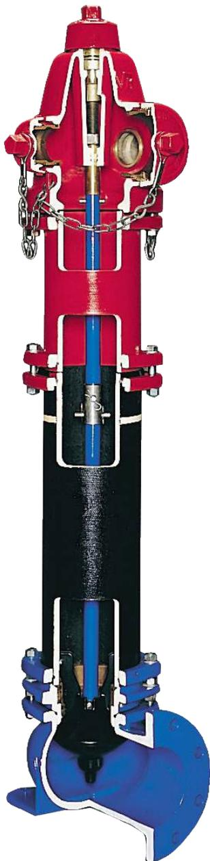
Le colonnine a secco con idranti antincendio sono progettate principalmente per le aree soggette al gelo, dove la condotta è situata al di sotto del terreno della zona gelata. Le colonnine a secco con idranti antincendio AVK soddisfano o superano l'AWWA C-502 e sono omologate UL/ULC e approvate FM. Sono progettate per garantire alte prestazioni, facili riparazioni e costi minimi di manodopera e stoccaggio per l'utente finale.
