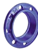
Serie 05 Flangia combinata per tubazioni in PVC-U, acciaio o ghisa sferoidale Non antisfilamento Ghisa sferoidale DN400-600 (PVC-U e ghisa) DN50-300 (acciaio) PN10/16
