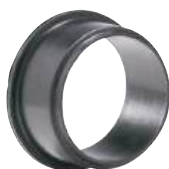
Serie 05 Tenuta per flangia combinata per tubazioni in PVC-U, acciaio o ghisa sferoidale Non antisfilamento Gomma SBR DN400-600 (PVC-U e ghisa) DN50-300 (acciaio)
