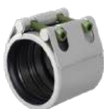
Serie 745/20 Giunto Repico® slip Universale e non-antisfilamento per tubi in metallo Tenuta in NBR o EPDM Acciaio inox AISI 316 DN15-600
