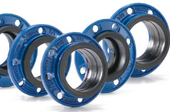
Il sistema a flangia combinata AVK comprende le flange combinate antisfilamento per tubazioni in PE, PVC e ghisa sferoidale nella versione DN50-300 e le flange combinate senza trazione per tubazioni in PVC, ghisa sferoidale e acciaio nella versione DN50-600. Le flange combinate sono adatte per l'utilizzo con acqua potabile e acque reflue.
