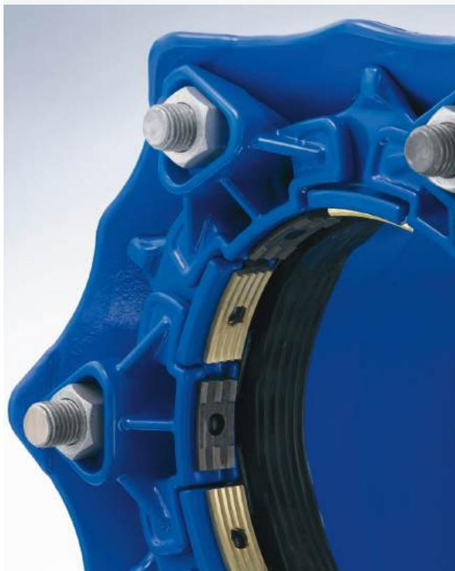
SupaGrip™, sistema brevettato di supporto della tenuta, è dotato di una staffa flessibile che, in combinazione con l'esclusivo design della presa, fornisce una tenuta superiore e una resistenza alla trazione su tutte le condotte indipendentemente dal materiale e dalla dimensione.
