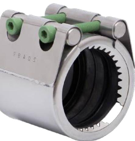
La gamma di giunti Repico® AVK in acciaio inossidabile 316 comprende giunti “Grip” resistenti a trazione per tubi metallici di tutti i materiali fino a DN400 e giunti “Slip” non resistenti a trazione per tubi di tutti i materiali fino a DN2000. I giunti Repico® sono adatti per l’utilizzo con acqua potabile e acque reflue.
