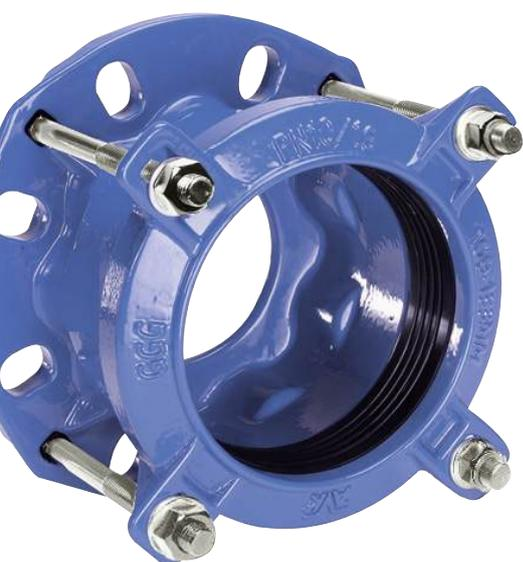
I giunti universali dritti, i giunti con riduzione e i giunti adattatori a flangia AVK Supa® sono adatti a tubazioni in PVC-U, ghisa, ghisa sferoidale, acciaio e cemento-amianto. I raccordi vanno dal DN40 al DN400 e sono adatti all'utilizzo con acqua potabile e acque reflue.
