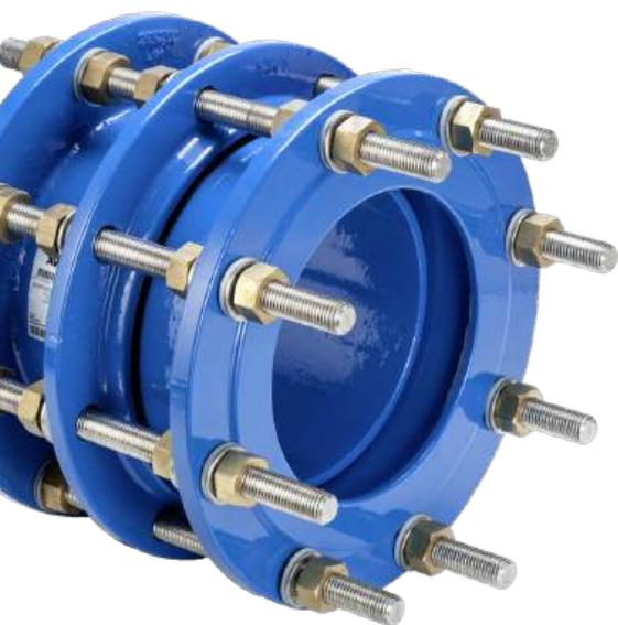
I giunti di smontaggio AVK facilitano l'installazione e lo smontaggio di tubazioni flangiate e attrezzature compensando lo spostamento assiale della tubazione durante l'installazione e lo smontaggio. La gamma è disponibile nella versione DN50-2600 in PN10/16 e fino DN1200 in PN25.
