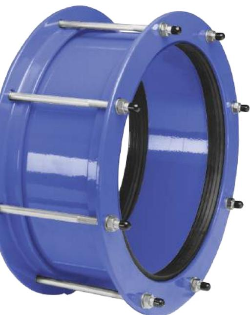
La gamma di raccorderia assemblata AVK comprende giunti dritti senza funzione di antisfilamento, giunti con riduzione e giunti adattatori a flangia nella versione DN350-2000. La gamma è adatta a tubazioni in ghisa, ghisa sferoidale, acciaio, PVC-U e vetroresina per l'utilizzo con acqua potabile e acque reflue fino a 25 bar.
