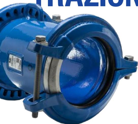
I giunti dritti universali e gli adattatori flangiati Supa One™ sono molto facili da installare: basta serrare un solo bullone da ciascuna estremità del raccordo e possono essere utilizzati con un normale utensile elettrico. Sono realizzati in ghisa sferoidale secondo la norma EN 545 per garantire robustezza e durata.
