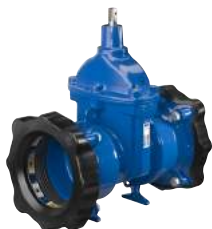
Serie 636 Valvola a saracinesca Supa Maxi™ Universale e antisifilamento per tutte le tubazioni Ghisa sferoidale DN80-300 PN16
