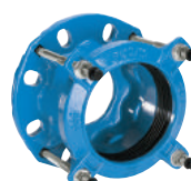
Serie 603 Adattatore flangiato Supa® Universale per tubazioni in PVC-U, cemento-amianto, acciaio, ghisa Foratura universale Ghisa sferoidale DN40-400 PN10/16
