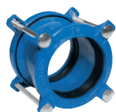
Serie 601 Giunto diritto Supa® Universale per tubazioni in PVC-U, amianto-cemento, acciaio, ghisa e ferro Ghisa sferoidale DN40-400 PN16
