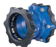
Serie 632 Giunto con riduzione Supa Maxi™ Universale e antisifilamento per tutti le tubazioni Ghisa sferoidale DN50-300 PN16
