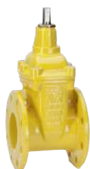
Serie 06/70 Saracinesca flangiata Corta DIN F4 DN40-600 PN10/16 Ghisa sferoidale Con rivestimento epossidico esterno
