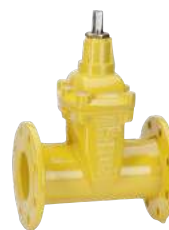
Serie 02/70 Saracinesca flangiata Lunga DIN F5 DN40-500 PN10/16 Ghisa sferoidale Con rivestimento epossidico esterno
