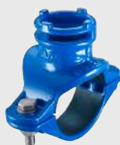
Serie 100/14 - collare di presa per tubi in ferro/acciaio, Ø60-223 mm, ghisa sferoidale.
