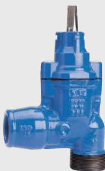
Serie 11/30 - Valvola ad angolo con filettatura maschio in ingresso e raccordo a bicchiere antisifilamento per tubi in PE in uscita.
