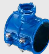
Serie 100/00 - Collare di presa per tubo in PE/PVC, Ø63-225mm, ghisa sferoidale. Disponibile anche con chiusura a lama.
