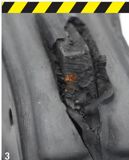
La guida sul cuneo ha uno spessore di gomma irregolare che ha provocato un carico irregolare durante il funzionamento. La gomma è distrutta e il nucleo è stato esposto, provocando corrosione (#3).
