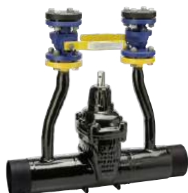
Serie 46/80 Saracinesca con estremità a saldare lunghe e due punti di spurgo DN80-600 PN16 Acciaio fuso GP240GH Rivestimento esterno PUR
