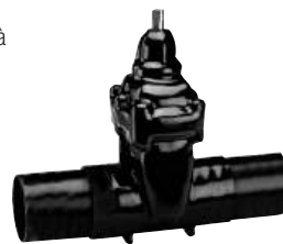
Serie 46/70 Saracinesca con estremità a saldare lunghe DN50-600 PN16 Acciaio fuso GP240GH rivestimento esterno PUR
