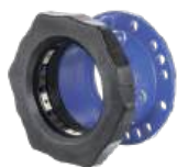
Serie 633/00 Giunto adattatore flangiato Supa Maxi™ Universale e antisfilamento DN40-800 PN10/16 Ghisa sferoidale
