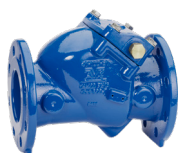
Serie 41/61 Valvola di ritegno Boccole chiuse Tenuta gommata DN50-300 PN10/16 Ghisa sferoidale
