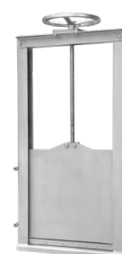
Serie 772/7172 Paratoia per canale Unidirezionale fino a 1000x1000 mm incluso, bidirezionale nelle dimensioni maggiori Con albero non saliente Acciaio inox AISI 304 200 x 200 mm - 2000 x 2000 mm
