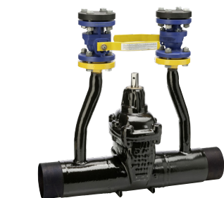
Serie 46/80 Saracinesca con estremità a saldare lunghe e due punti di spurgo DN80-600 PN16 Acciaio fuso GP240GH Rivestimento esterno PUR
