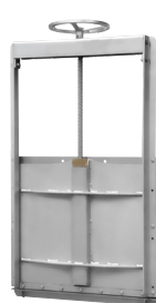
Serie 772/61 Paratoia a muro Bidirezionale fino a 1200x1200 mm incluso, bidirezionale o unidirezionale nelle dimensioni maggiori Con albero non saliente Acciaio inox AISI 304 200 x 200 mm - 2000 x 2000 mm
