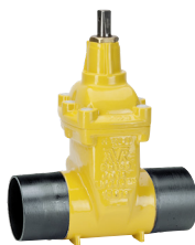
Serie 46/64 Saracinesca con estremità a saldare corto DN50-300 PN16 Acciaio fuso GP240GH Rivestimento epossidico esterno
