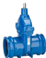
Serie 01/80 Saracinesca con estremità a bicchiere 'Euro' per tubi in uPVC DN40-400 PN16 Ghisa sferoidale
