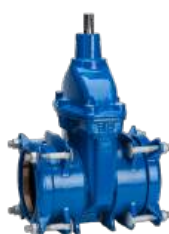
Serie 01/70 Saracinesca con estremità Supa Plus™ antisfilamento per tubi in PE e uPVC DN40-300 PN16 Ghisa sferoidale
