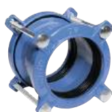
Serie 601 Giunto dritto Supa® universale per tubi in uPVC, AC, acciaio, ghisa e ghisa sferoidale Ghisa sferoidale DN40-400 PN16
