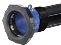
Serie 635 Giunto di transizione Supa Maxi™ con tronchetto in PE PN10 o PN16 Universale e antisfilamento per tutti i tubi Ghisa sferoidale DN50-300 PN10/16
