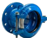
Serie 653/00 Giunto adattatore flangiato Supa One™ Universale per tubi in ghisa, acciaio, PVC e PE DN80-200 PN16 Ghisa sferoidale
