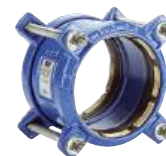
Serie 621/10 Giunto dritto Supa Plus™ Antisfilamento per tubi in PE e uPVC Ghisa sferoidale DN32-300 PN16
