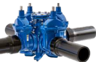
Serie 18 Saracinesca combi con 4 uscite con tronchetti in PE DN100-200 PN10/16 Ghisa sferoidale
