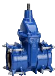
Serie 01/70 Saracinesca con estremità Supa Plus™ antisfilamento per tubi in PE e uPVC Ghisa sferoidale DN40-300 PN16
