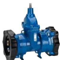
Serie 636 Saracinesca con estremità Supa Maxi™ universale antisfilamento per tubi di tutti i tipi DN80-300 PN16 Ghisa sferoidale
