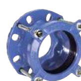
Serie 603 Giunto adattatore flangiato Supa® universale per tubi in uPVC, AC, acciaio, ghisa e ghisa sferoidale Foratura universale Ghisa sferoidale DN40-400 PN10/16
