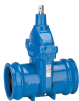
Serie 01/80 Saracinesca con estremità a bicchiere 'Euro' per tubi in uPVC DN40-400 PN16 Ghisa sferoidale
