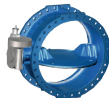
Serie 756/102 Valvola a farfalla Doppio eccentrico Flangiata Sede in acciaio inox riduttore con flangia ISO DN150-2800 PN10/16 Ghisa sferoidale
