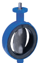
Serie 75/10 Valvola a farfalla Centrica con sede di tenuta fissa Wafer DN40-1400 PN10/16 Ghisa sferoidale
