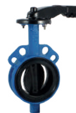
Serie 820/00 Valvola a farfalla Centrica con sede di tenuta sostituibile Wafer DN25-1000 PN10/16 Ghisa sferoidale
