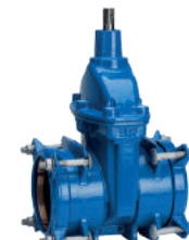
Serie 01/70 Saracinesca con estremità Supa Plus™ antisifilamento per tubi in PE e uPVC DN40-300 PN16 Ghisa sferoidale
