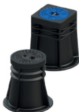
Serie 80/31 Chiusino 'Classic' secondo DIN 4056 per valvole di distribuzione Altezza fissa Corpo in PA+
