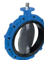
Serie 75/41 Valvola a farfalla Centrica con sede di tenuta fissa Lug DN50-1200 PN10/16 Ghisa sferoidale
