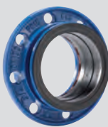
Serie 05 Flangia combi antisfilamento in ghisa sferoidale per tubi in PE/uPVC DN 50-300 non antisfilamento DN 50-600 (PVC) PN 10/16
