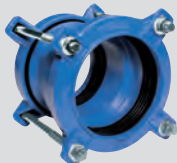
Serie 601 Manicotto Supa® in ghisa sferoidale per uPVC, fibrocemento, acciaio, ghisa e ghisa sferoidale DN 40-400 PN 16
