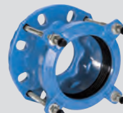
Serie 602 Giunto a gradino Supa® in ghisa sferoidale per uPVC, fibrocemento, acciaio, ghisa e ghisa sferoidale DN 40-400 PN 16
